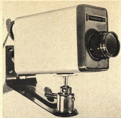
Bild 4. Sehr einfach aufgebaute Überwachungskamera von Matsushita. Die Schärfereinstellung erfolgt mit Hilfe des Objektivs (Aufnahme: Schwahn)
