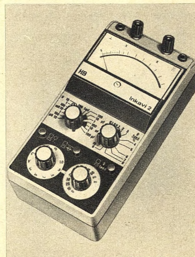
Bild 2. ► LC-Meßbrücke mit Verlustwinkelabgleich Typ Inkavi 2 (Hartmann & Braun)
