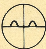
◀ Bild 1. Wiedergabe eines Sinussignals am Ausgang des Verstärkers kurz nach dem Einschalten
