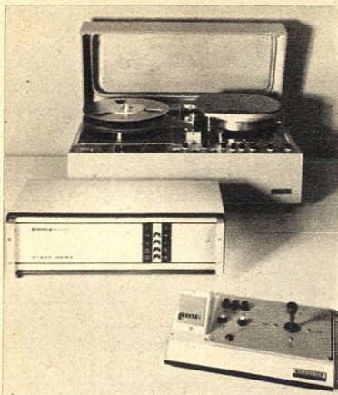
Bild 12. Grundig-Videorecorder BK 200 mit nach dem FAM-System arbeitenden Farbzusatzgerät, dem ein Pal-Codier- oder Decodiereinsatz beige-fügt werden kann. Vorn das Pult für die Fernsteuerung aller wichtigen Funktionen
